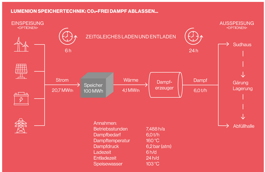
Grafik Musteranwendung: Einsatz eines Hochtemperatur-Stahlspeichers im Braubetrieb
